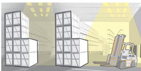
Rys. 4 - Oświetlenie po wykryciu ruchu w pomieszczeniu
